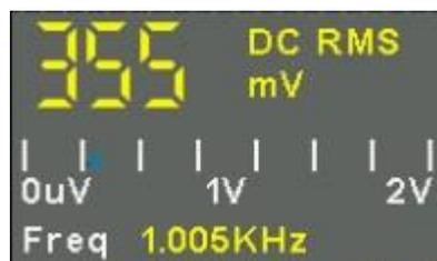
数字电压表框中间显示的是当前测量电压值与用所选伏/格（旋转伏/格旋钮）计算屏幕上垂直方向的 8 个网格对应的量程的相应比例。
