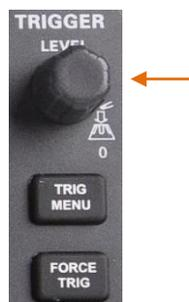
触发电平旋钮
